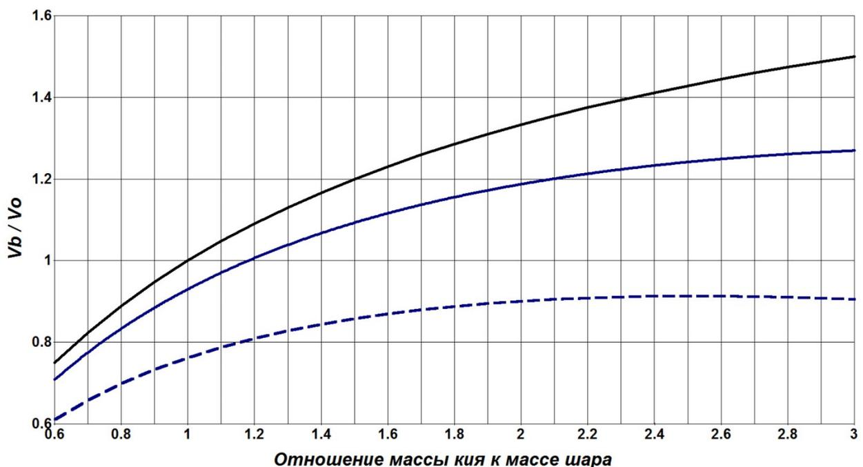
Рис.6. Зависимость отношения скоростей шара и кия от отношения масс кия и шара  $\alpha_s$ .
