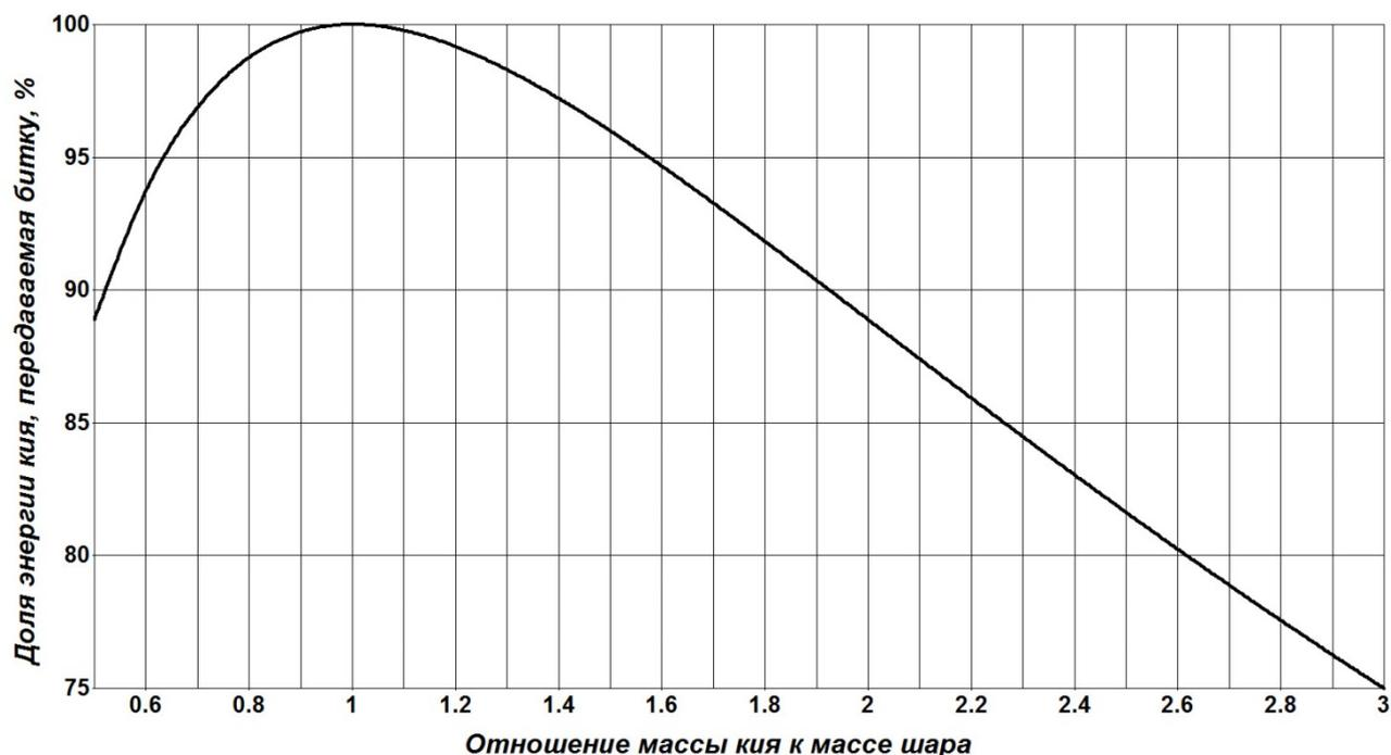
Рис.2. Зависимость  $T_b / T_0$  – доли энергии кия, которую при ударе получает биток, от отношения масс кия и шара  $\alpha_s$ .
