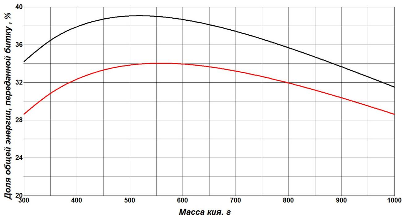
Рис.9. Зависимости  $T_b / T$  – доли общей энергии, которую при ударе получает биток, от массы кия для мужчин и женщин.
