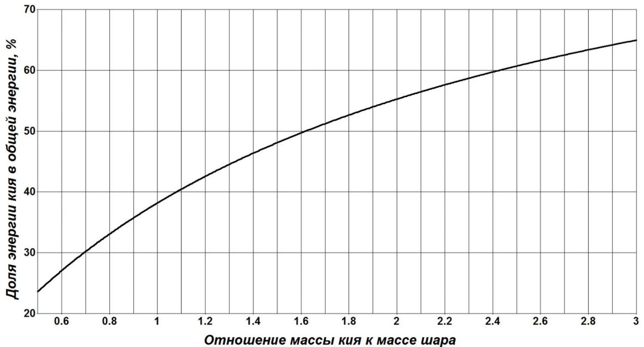
Рис.3. Зависимость  $T_0 / T$  – доли энергии кия в общей энергии от отношения масс кия и шара  $\alpha_s$ .
