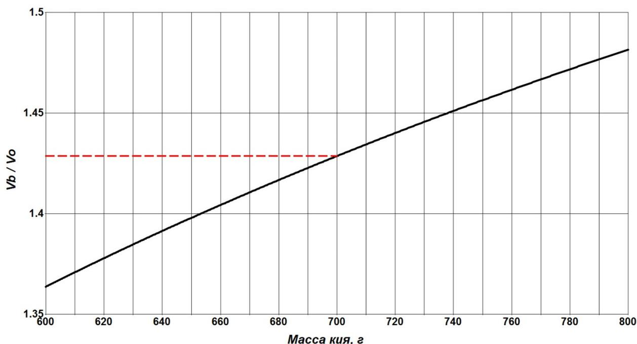
Рис.1. Зависимость отношения скоростей шара и кия  $V_b / V_0$  от массы кия  $M_s$ .
