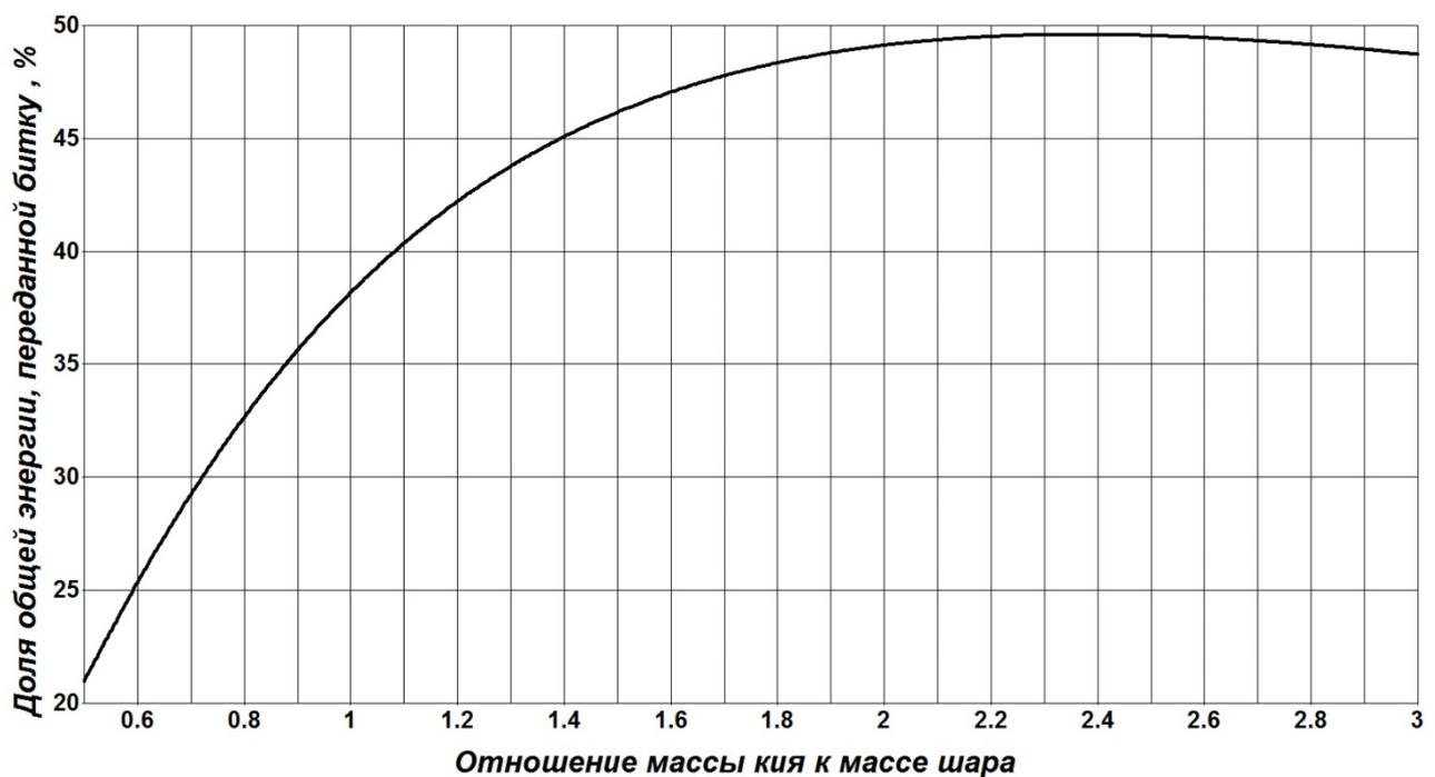
Рис.4. Зависимость  $T_b / T$  – доли общей энергии, которую при ударе получает биток, от отношения масс кия и шара  $\alpha_s$ .
